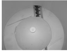
Mieszacz paliwa z stożkiem i łopatkami
