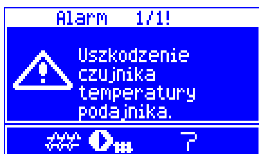
Rys. 46 Widok alarmu „uszkodzenie czujnika temperatury podajnika”.
