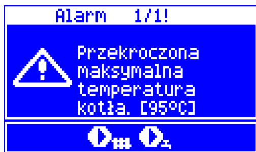
Rys. 44 Widok alarmu przegrzania kotła.
